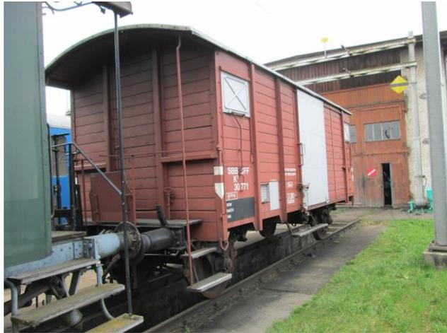
Dieser 1897 für die Schweizerische Centralbahn als KR1 1332 gebaute Güterwagen konnte 2007 durch die DBB von der SERSA AG übernommen werden. Bei der SBB erhielt er 1902 die Bezeichnung K2 31502. Bei der Komplettmodernisierung wurde er 1957 zum K2 30771 und 1968 zum Gklm 20 85 111 6 485-6 umgezeichnet.
