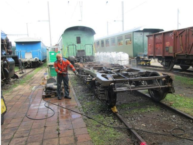
Trotz recht kühler Temperatur wird auch auf dem Aussenplatz gearbeitet: Mit dem Hochdruckreiniger wird dem grössten Dreck an den beiden Sennhütte-Drehgestellen zu Leibe gerückt. Auch am Habersack (links am Bildrand) waren noch einige „Nacharbeiten“ im Kessel nötig. Der BC 5117 hingegen (Mitte oben) wartet auf seinen Hilfsdrehgestellen darauf, dass ab dem nächsten Frühjahr auch an seinen Drehgestellen wieder weitergearbeitet werden kann.
