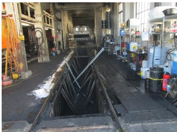
Während die beiden Loks Habersack und BSB 51 draussen vor dem Depot an der frischen Luft für die Überwinterung vorbereitet werden, werden die Innengrube des Gleises 51 und deren nähere Umgebung gereinigt. Die Ölauffangwannen werden entleert und abgedampft, Schlamm und Aschereste aus der Grube entfernt und diese dann wieder einmal gekärchert
