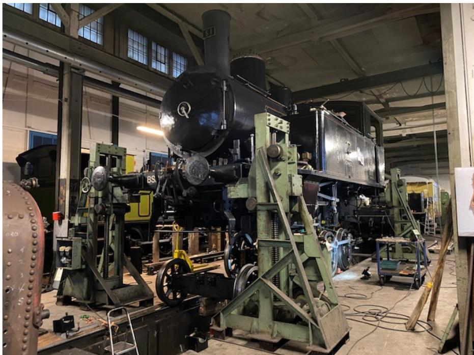
So hoch musste Lok BSB 51 am 12.12. angehoben werden, bis die Achsen darunter weggerollt werden konnten. Anschliessend wurde die Lok wieder auf «Normalhöhe» abgesenkt, so dass auch am Lokrahmen gründliche Reinigungsarbeiten durchgeführt werden können. Es ist das erste Mal, dass die Lok nach ihrer Wiederinbetriebnahme vor 12 Jahren komplett ausgegacht wurde. Foto Marco Johann
