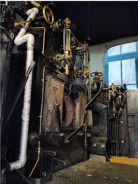
Blick in den (fast) kompletten Führerstand unserer Lise. Aufmerksamen Beobachtern wird auffallen, dass sich die Betätigungsgriffe für die Kessel-Wasserstandsanzeiger nicht mehr beim oberen dampfseitigen Reiberhahn befinden, sondern beim unteren wasserseitigen. Bisher «kollidierte» der Regulatorhebel nämlich immer mit dem führerseitigen Wasserstandsgriff und sorgte so bei Lokführern des öfteren für eingeklemmte Finger. Solches sollte jetzt dann nicht mehr vorkommen.
