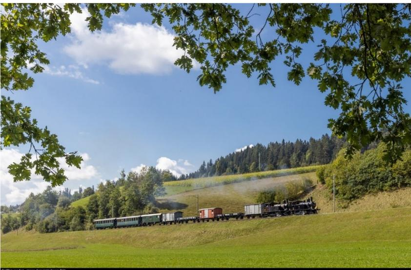
Mit Volldampf erstürmen die beiden Loks SMB 2 und BSB 51 mit einem ansehnlichen GmP die Steigung des Griesbach, anlässlich des privaten Foto-events vom 03./04. September. Bei der «finalen» Verschiebung von der Haltestelle Griesbach nach Affoltern-Weier waren die Regler beider Loks voll geöffnet, die Steuerungen bei 35% ausgelegt und die Geschwindigkeit lag bei satten 40 km/h, was entsprechende «Kaminmusik» erzeugte.
