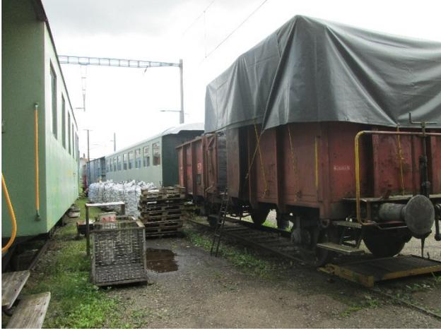
Blick auf den, zur Hälfte zum Sandstrahlwagen umfunktionierten Kohlenwagen. Das Abteil mit der Sandstrahlanlage ist an der erhöhten Blachen-abdeckung gut erkennbar. In der 2. Wagenhälfte fanden nun 8t Lokomotivkohle Platz. Die restlichen 15t lagern in Big-Bags im Hintergrund neben dem BC 5117. Halt:  $8+15 =$  nur 23, wo ist die 24. Tonne? Die lieferte zum einen den Dampf an den beiden Probefahrttagen bzw.. lagert jetzt im Kohlenkasten von Lok 51.
