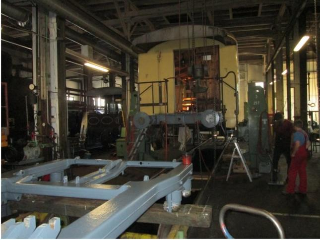
Schlussspurt bei den Revisionsarbeiten an der Sennhütte: Im Vordergrund der fertige Drehgestellrahmen, im Hintergrund sind die Montagearbeiten der revidierten Puffer und des Zugapparates im Gang. Die Auffrischungsarbeiten im Wageninnern sind abgeschlossen, das für die Whiskytrain-Fahrten benötigte Mobiliar wurde montiert und eingebracht, die aufgearbeiteten und z.T. ersetzten Plattform- und Trittbretter sind montagebereit.
