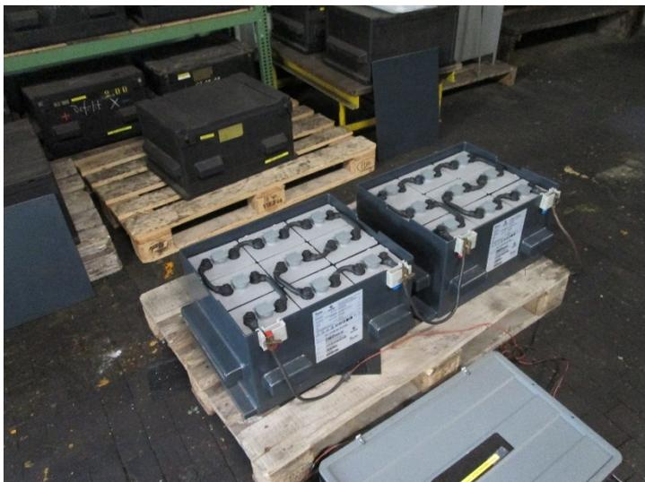
Nicht ganz billig waren die 6 angeschafften Wagenbatterien. So können die am häufigsten eingesetzten 3 Wagen mit absolut neuen solchen Stromspendern ausgerüstet werden. Defekte Elementaus alten Batterien können nun durch noch intakte Elemente ausgetauscht werden, so dass weiterhin auch eine gewisse Anzahl «alter» Batterien einsatzfähig sein werden.
