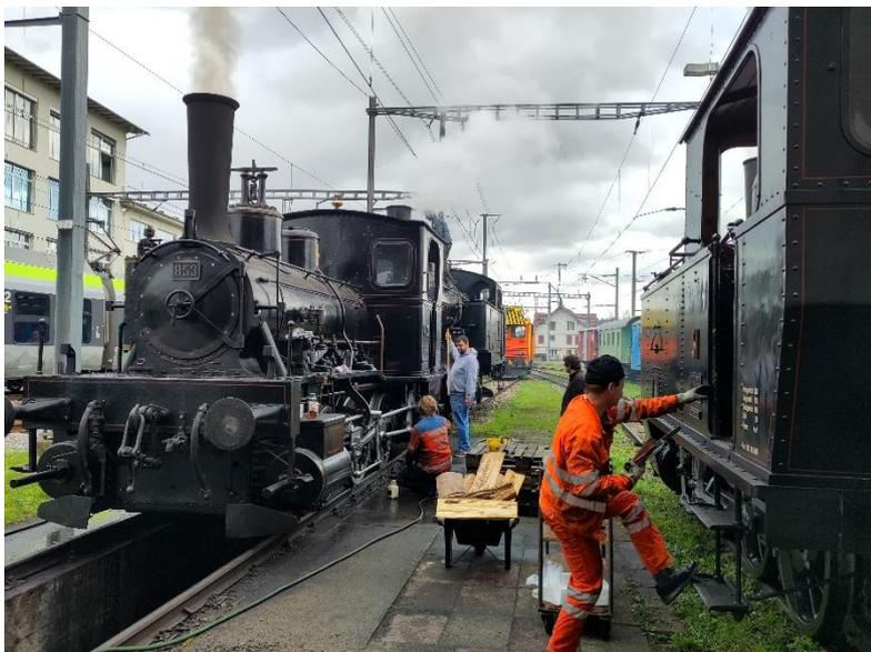
Am 16.03. wurden unsere 3 einsatzfähigen Dampflok für die äusseren Kesselinspektionen angeheizt. Während dem Anheizen werden noch verschiedene Reinigungsarbeiten vorgenommen, das Inventar kontrolliert und ggf. ergänzt und die Führerstände aufgeräumt. Der Habersack wird nach bestandener Kesselinspektion gleich noch einen ersten Probelauf absolvieren.
