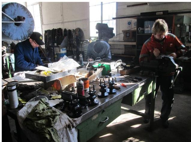
Mit Hochdruck wird an Teilen des Habersacks gearbeitet: Während sich Martin (links im Bild) den Flächen des Regulatorschiebers widmet, reinigt und poliert Stefan (Bildmitte) die Dampfentnahmehahnen. Diese werden mit neuen Sitzen (Teflon) ausgerüstet, damit sie wieder ganz dicht schliessen. Im Bild rechts ist Marco mit dem Zusammenstellen der revidierten Klinger-Wasserstandsanzeiger beschäftigt
