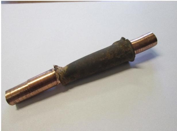
So sieht ein, von Demian Soder mit Kronenbohrer ausgebohrter Stehbolzen des Lisekessels aus. Deutlich erkennbar die unregelmässigen, sehr starken Ab-zehrungen auf der Wasserseite. Gemäss Zeichnungen sollte der ursprüngliche Schaftdurchmesser wasser-seitig 21mm betragen. An der dünnsten Stelle beträgt sie beim abgebildeten Exemplar noch gerade knapp 12mm! Insgesamt werden nun 200 Stehbolzen und alle 60 Deckenan-ker ersetzt.
