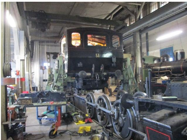
30.01.2021, Werkstattatmosphäre pur in Konolfingen: Rechts im Vordergrund das Fahrgestell der Lise, im Hintergrund Lok GTB 3. Vorne in der Mitte die Trieb- und Kuppelachsen von Lok 51, links daneben auf einem Transportwagen das Laufachsgestell und hinten in der Mitte die «höhergelegte» Lok 51.
