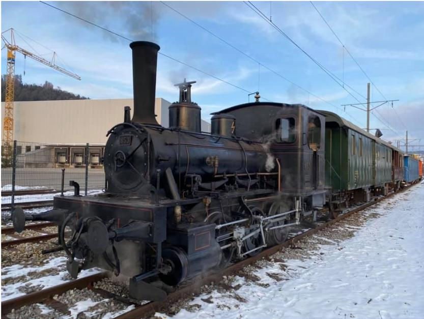
Nachdem vorgängig die Siederohre nachgewalzt und der Regulator intensiv eingeschliffen wurden, konnte nach dem Zusammenbau die Lok 853 am 09.01.2021 probetalber angeheizt werden. Nach fast 12-jährigem Stillstand haben Luftpumpe und Injektoren auf Antrieb problemlos funktioniert. In kurzen Probefahrten durch den Bahnhof Konolfingen, selbstverständlich mit Anhängelast, konnte auch die Antriebsmechanik auf einwandfreies Funktionieren getestet werden. Die Lok wird
