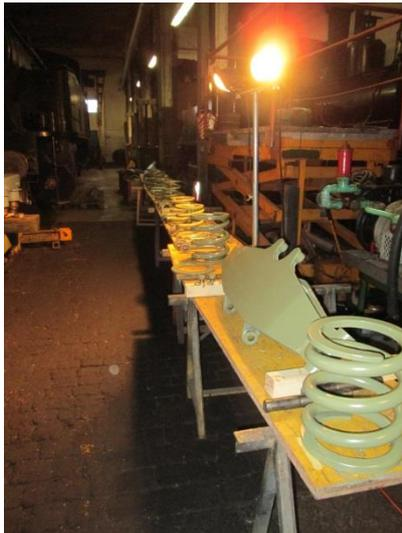
Schier endlos reihen sich die aufgearbeiteten „Kleinteile“ des sich in Revision befindenden Drehgestells des Bi 524 auf dem Malertisch aneinander und wollen 2 Mal grundiert und 2 Mal grau gestrichen werden.
