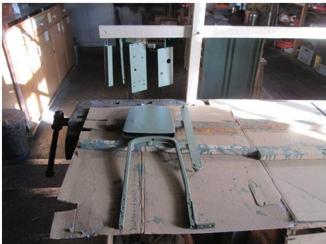
Aufwändig und auch mühsam ist die Aufarbeitung der Fensterhebevorrichtungen des BCF 4652, obschon die Grundsubstanz besser erhalten ist, als es der äussere Zustand vermuten lässt.
