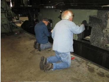
Die Räder und die Hezenseite des Rahmens der Lise sind frisch grundiert, Edgar und Rolf sind daran, die Führerseite des Rahmens mit Korrosionsschutzfarbe zu behandeln.
