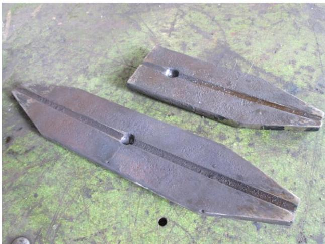
Blick auf die defekten beiden Federblätter der Laufachsfederung von Lok BSB 51:
