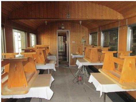
Das Innere des BC 5117 (ex BRi 5117) ist schon fast fertig. Es bleiben noch einige Auffrischungsarbeiten im WC-Bereich und die „Baureinigung“. Im Winter sollen der Wagen von den Drehgestellen gehoben werden, damit diese gründlich revidiert werden können. Zwei Achsen müssen auch neu bandagiert werden. Das und auch die Kontrolle/Überarbeitung der Achslager wird an eine externe Firma vergeben.
