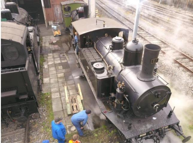
Drohnenfoto vom März 2017: nach der erfolgreichen Kesselinspektion wird bei Lok die Dichtheit der überarbeiteten Zerstäuberleitung getestet. Dicht war sie, doch das noch zwischen Zylindergehäuse und Schieberdeckel liegende-gebliebene Heissdampföl machte sich, natürlich erst als es entsprechend heiss war explosionsartig davon. Zum Glück trug der, dessen Nase zuvorderst war eine Brille...
