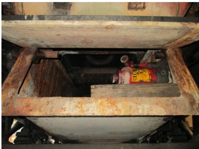
Das „Pièce de Resistance“ im Aschenkasten des Habersacks: die Demontage des innenliegenden Funkengitters. Die als Scharnier wirkende Welle musste durchgetrennt werden und die beiden verbliebenen „Stummel“ (links und rechts oben im Kasteninnern) konnten nur mittels rohester Gewaltanwendung entfernt werden. Da das eigentliche Funkengitter gelegentlich entfernt und ersetzt werden muss, wird die neue Welle bedeutend „bedienerfreundlicher“ konstruiert werden müssen.
