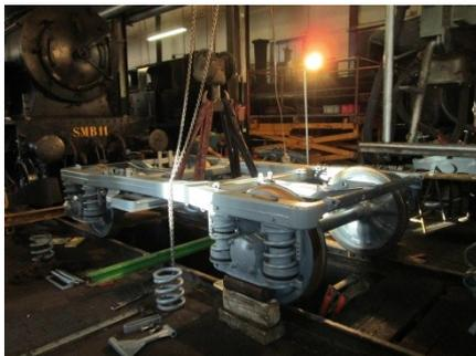
Der Zusammenbau des Drehgestells 2 zum Bi 524 ist in vollem Gange. Bereits steht der Rahmen wieder auf den Achsen, im Moment wird die Kastenabfederung zusammengestellt, um dann wieder montiert zu werden.
