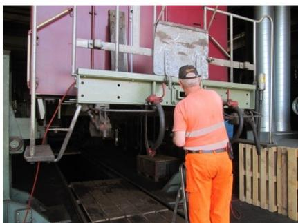
Während auf der anderen Seite der Zusammenbau des Drehgestells 2 vorangeht, wird hier die rostsanierte Partie um den Stossbalken des Wagens grundiert
