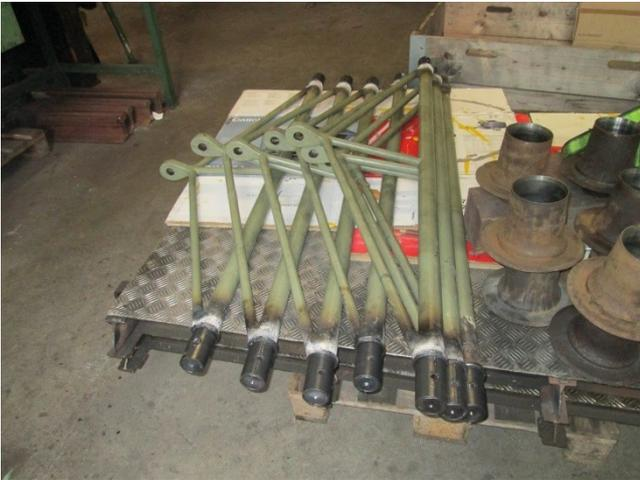
Blick auf die aufgearbeiteten „Bremsdreiecke“ des BC 5117: das Überdrehen geschah in Bauma beim befreundeten DVZO auf der grossen Drehbank. Auf die nun auf einheitliches Mass gebrachten Zapfen wurden neue, genormte Büchsen aufgedrückt, so dass die Klotzhalterungen wieder zuverlässig darauf befestigt werden können.
