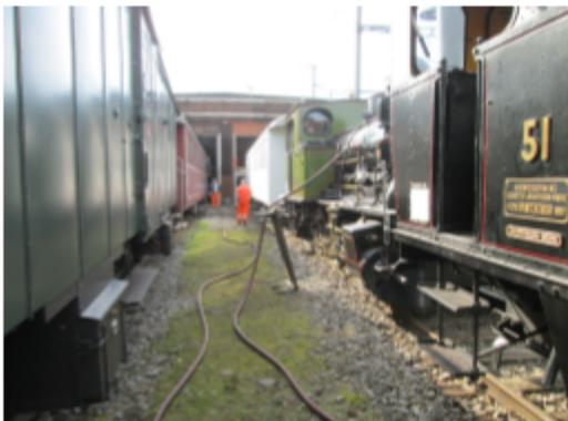
Die frühlingshaften Temperaturen erlaubten am 11.03. viel „Aussenarbeit“: Während im Hintergrund rechts am „Silberling“ Dachschleifarbeiten ausgeführt wurden, wurde bei Lok GTB 3 der Kessel mit Wasser gefüllt und auf Dichtheit geprüft. Bei Lok BSB 51 wurden im Führerstand die Wasserstandsanzeiger eingeschliffen und vorne am Langkessel die Speisekopfreiber überarbeitet.
