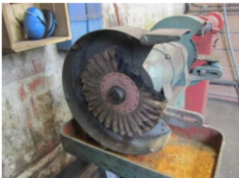
Da ging wohl was schief! Die noch recht neue Schwabbelscheibe an der grossen Schleifmaschine in der Schmitte wurde aus Unachtsamkeit angesengt. Passiert ist es wohl beim Ausglühen von Kupferdichtungen. Kann ja mal passieren.
